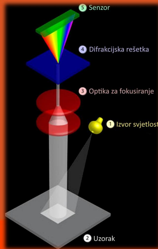
Ispitivani uzorak se postavlja na podložak iznad izvora svjetlosti.
