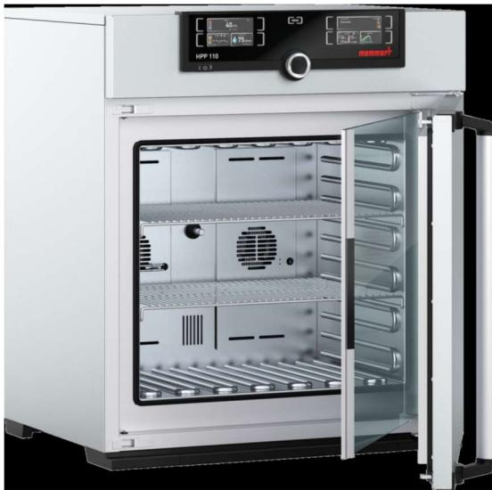
Testna komora (klima komore) s mogućnošću preciznog podešavanja atmosferskih parametara: temperatura, vlaga i svjetlo. Klima komora, s odgovarajućim rasponom navedenih parametara, omogućuje simuliranje uvjeta kojima su prehrabeni proizvodi izloženi bilo tijekom čuvanja u skladištima, bilo tijekom distribucije ili izlaganja na prodajnim mjestima.
