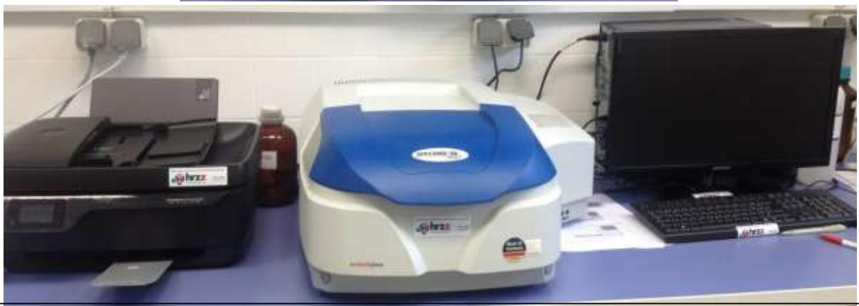
Uređaj: Specord 50 PLUS UV/VIS spektrofotometar (Analytik Jena, Jena, Njemačka)
