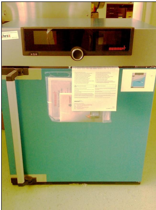
**UREĐAJ:** CO<sub>2</sub> inkubator za uzgoj animalnih stanica
