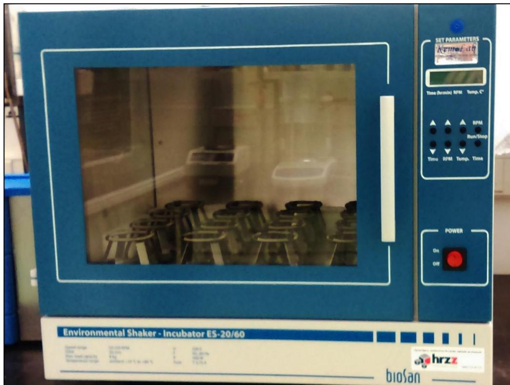
**UREĐAJ:** Orbitalni homogenizator/inkubator
