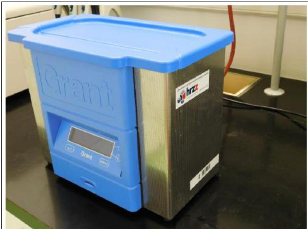
**UREĐAJ:** Ultrazvučna kupelj
