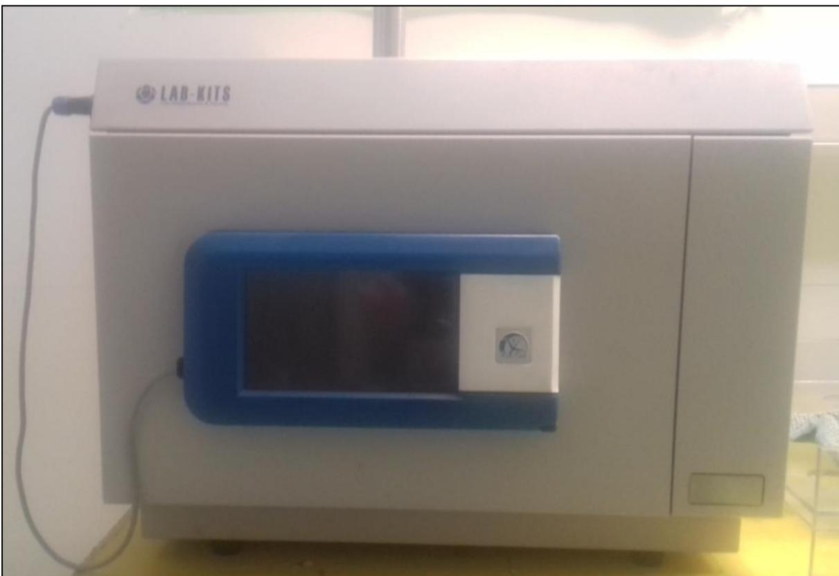
**UREĐAJ:** Ultrazvučno-mikrovalni reaktor
