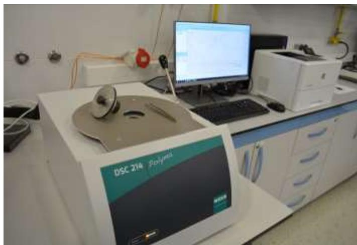
DSC je najčešće korištena tehnika toplinske analize kojom se mjere entalpijske promjene u uzorcima uslijed promjena fizikalnih i kemijskih svojstava u zavisnosti o vremenu i temperaturi.
