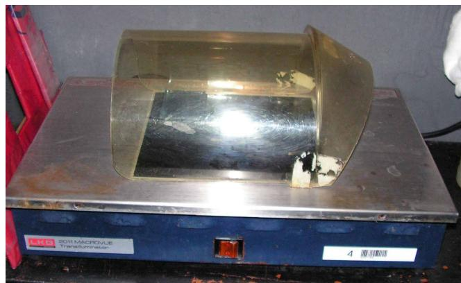
**Opis metode:** Najjednostavniji i najčešće korišteni postupak za detekciju nukleinskih kiselina u gelu jest bojanje gela sa etidij-bromidom i naknadna vizualizacija nukleinskih kiselina u gelu, koja se ostvaruje njegovim ozračivanjem sa UV-svjetlom. Pri tome etidij bromid vezan na nukleinske kiseline emitira elektromagnetsno zračenje valne duljine 590 nm, koje se lagano uočava golim okom.
