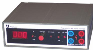
**Kratki opis metode:** elektroforeza predstavlja gibanje otopljene tvari kroz fluid pod utjecajem ravnomjernog električnog polja. Najčešće se koristi pufer uklapljen u gel agaroze, koji pruža mehanički otpor kretanju otopljenih čestica. Time se postiže razdvajanje otopljenih čestica u odnosu na njihov naboj i veličinu.
