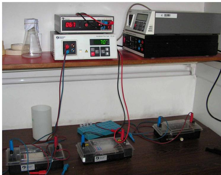
**Kratki opis metode:** elektroforeza predstavlja gibanje otopljene tvari kroz fluid pod utjecajem ravnomjernog električnog polja. Najčešće se koristi pufer uklapljen u gel agaroze, koji pruža mehanički otpor kretanju otopljenih čestica. Time se postiže razdvajanje otopljenih čestica u odnosu na njihov naboj i veličinu.
