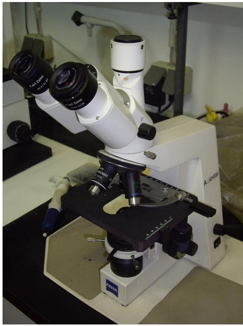
**UREĐAJ:** Transmisijski svjetlosni mikroskop
